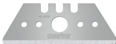
Die TRAPEZKLINGE NR. 65232 von MARTOR ist eine hochwertige Klinge aus Stahl. Sie ist sehr scharf und verfügt über zwei nacheinander nutzbare Schneidkanten für eine höhere Einsatzzeit. Der Breitschliff erleichtert das Schneiden, die abgerundeten Spitzen erhöhen Ihre Sicherheit. Die Klinge ist 50,1 mm lang, 19 mm breit und 0,63 mm stark.
