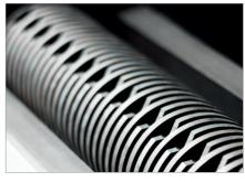
Schneidwellen aus gehärtetem Vollstahl
