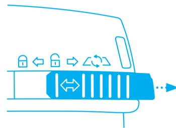
Ziehen Sie die 3in1-Sicherung in die **hinterste Position**.
