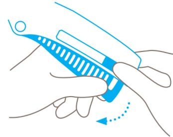
Danach drehen Sie den Hebel komplett **aus dem Griff heraus** und öffnen Sie die Klingendeckung.
