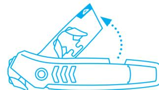
Ziehen Sie das **Klingenmagazin oben heraus**. Dadurch lösen Sie die Arretierung des montierten Klingenkopfes.
